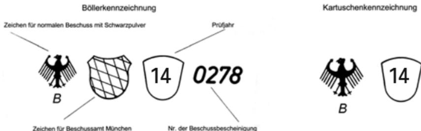
Abb. 3: Beispiele für Kennzeichnungen der Beschussämter
